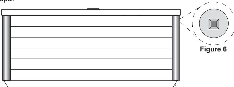
**Figure 6** Enlever les panneaux de coin en premier, puis enlever le panneau avant. Vous aurez besoin d'un embout carrés #2 pour les panneaux de coin.
