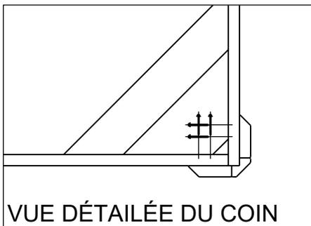
FIXER CHACUN DES DEUX POTEAUX AUX DEUX COINS FORMÉS PAR LES POUTRELLES DE RIVE EN FAISANT PASSER 4 VIS DE 2 ½ PO À TRAVERS LE COIN INTÉRIEUR DES POUTRELLES DE RIVE, COMME L'INDIQUE LA VUE DÉTAILLÉE DU COIN.
