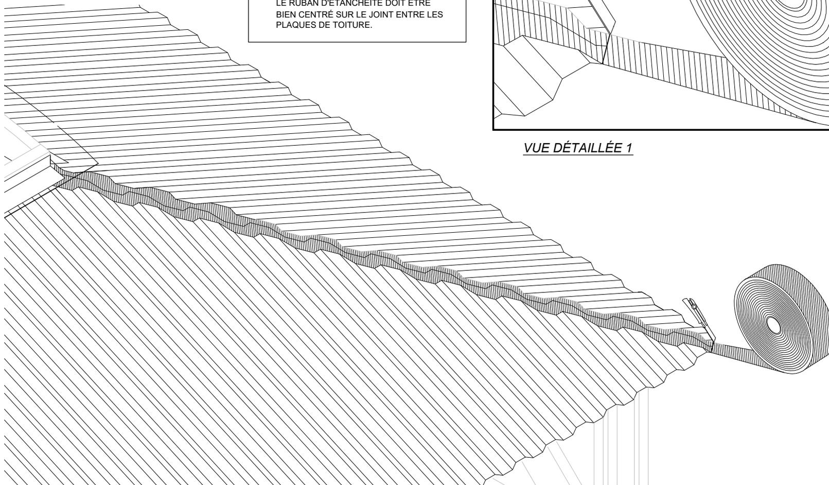
DÉPOSER LES RECOUVREMENTS DE JOINT DE TOITURE EN MÉTAL, COMME ILLUSTRÉ.
