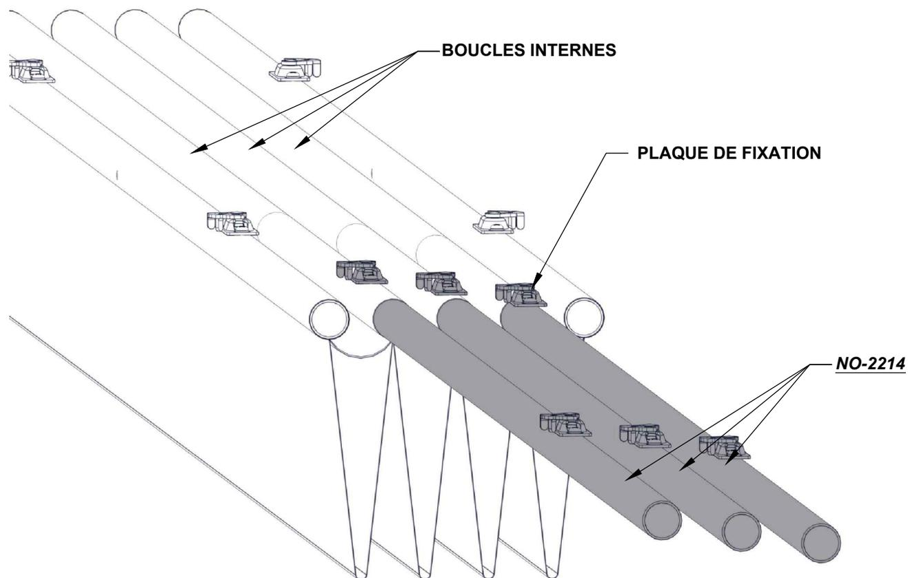
DISPOSER UN BOULON À CŒIL ET UN ÉCROU DE SERRAGE (NO 2222) DANS LE TROU PRÉ-PERCÉ SITUÉ AU CENTRE DE LA TIGE EXTÉRIURE.
