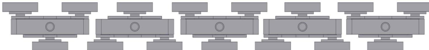
FIXER LE RAIL EN ALUMINIUM (NO 2274) À LA POUTRE EN 2X6 EN FAISANT PASSER DES VIS DE 1 1/2 PO DANS LES TROUS PRÉ-PERCÉS.
