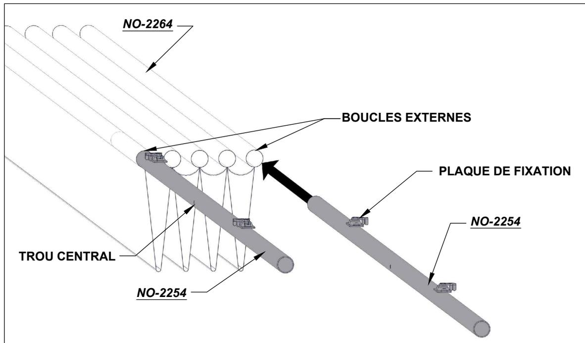
INSÉRER DÉLICATEMENT LES TROIS AUTRES TIGES (NO 2214) DANS LES BOUCLES INTERNES DU TISSU PARE-SOLEIL JUSQU'À CE QUE LES PLAQUES DE FIXATION DES TIGES SOIENT ALIGNÉES AVEC LES OUVERTURES DANS LE TISSU.
