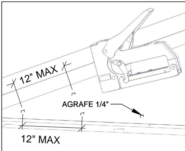
LE SUPPORT DE TÔLE DE TOIT (DC 3074) DOIT ÊTRE SITUÉ SUR LE PAPIER GOUDRONNÉ ET SOUS LE TÔLE DE TOIT.
