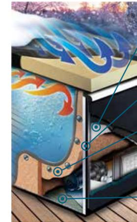
Panneau en mousse muni d'un film métallique réfléchissant la chaleur vers l'intérieur. Similaire à l'approche SmartSeal<sup>MC</sup>
